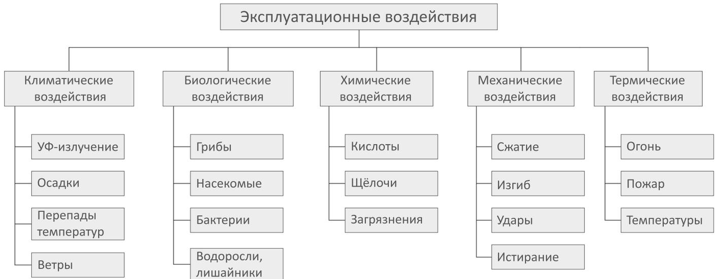
Схема 1. Виды эксплуатационных воздействий на конструкции зданий и сооружений
